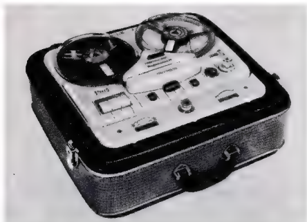
Bild 1. Das Magnetophon 85 Stereo. Es besitzt zwei Geschwindigkeiten 9,5 und 19 cm und einen Frequenzumfang von 30...20 000 Hz bei 19 cm/sec Bandgeschwindigkeit. Das Gerät ist neben einkanaliger Aufnahme/Wiedergabe auch für stereofone Wiedergabe eingerichtet. Es verfügt über zwei unabhängige Transistor-Stereo-Vorverstärker
